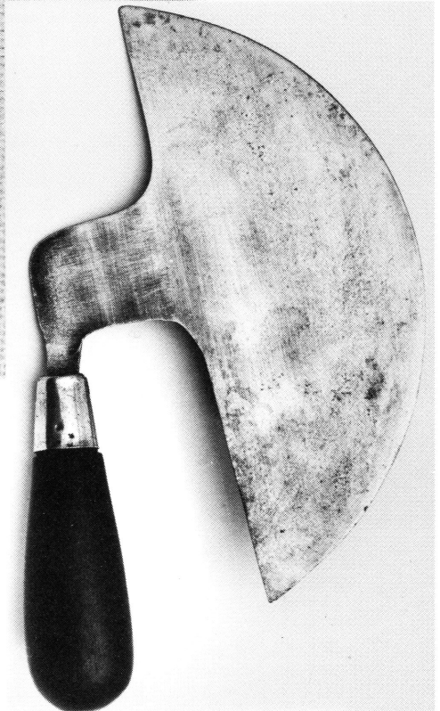
Abb. 8: Der 16,5 cm lange Halbmond der Fa. Blanchard, Besitzer ist Herr Melchior in Trebur, von Beruf Sattler.
