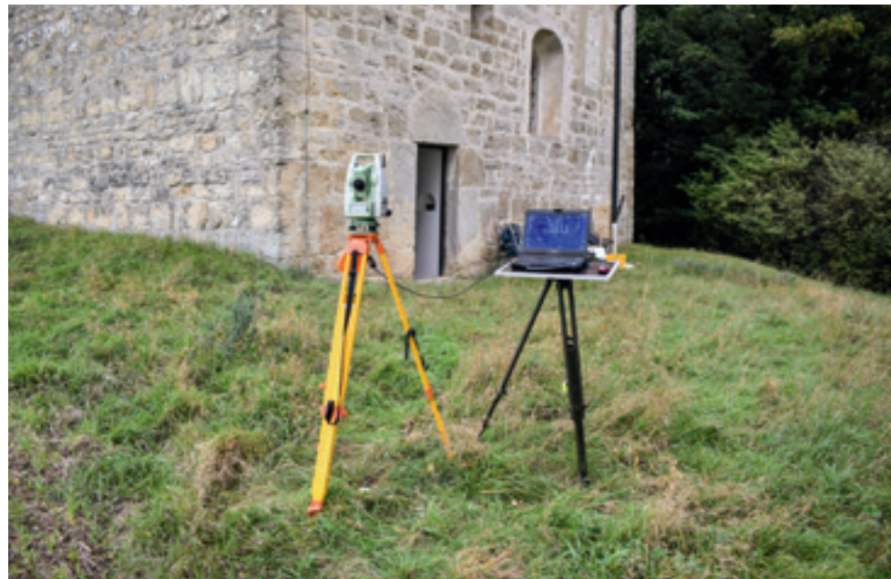
Abb. 4: Tachymetrische Messstation im Südwesten der Kirche
